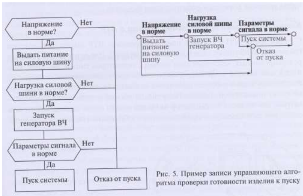
Рис. 5 Приклад запису управляючого алгоритму перевірки готовності виробу до пуску
