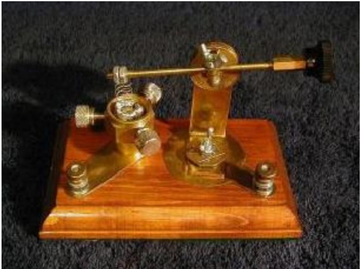
Один из первых кристаллических детекторов — "Кошачий ус" Пиккарда
