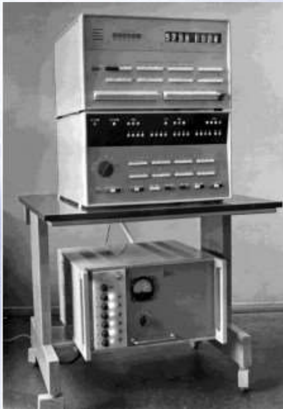
Комп'ютер М-180 для автоматизації масових лабораторних експериментів, 1975 р.
